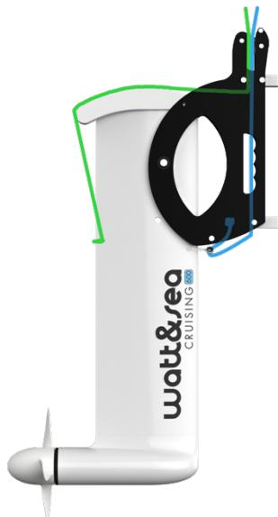
*Schéma de montage des bouts d'immersion et de relevage*
